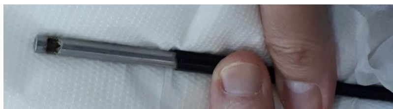
Εικόνα 2.3 Αριστερά: τυπικά είδη εμπορικών θερμίστορ. Δεξιά: το θερμίστορ που θα χρησιμοποιήσετε στο πείραμα, με το μεταλλικό του περίβλημα και το καλώδιο.
